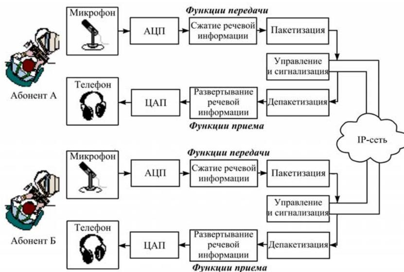
Рис. 1.1. Сценарий IP-телефонии «компьютер-компьютер»
