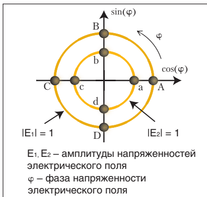
Рис. 19. Амплитудно-фазовая диаграмма 8-символьного сигнала ASK-QPSK
